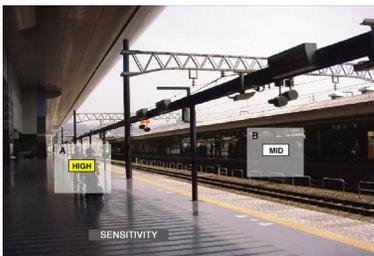
**Remarque:** Suivant la position des secteurs de détection programmés, les indications de sensibilité des secteurs de détection risquent d'apparaître chevauchées.
