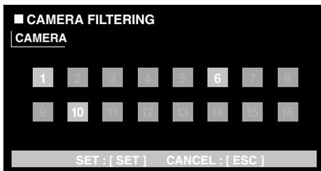
Sélectionner les numéros de canal de caméra vidéo (1 - 16 pour le modèle WJ-HD316, 1 - 9 pour le modèle WJ-HD309) en utilisant les boutons fléchés pour appliquer le filtrage. Il est possible de sélectionner les canaux de caméra vidéo en utilisant les boutons de sélection de caméra vidéo [1] - [16] pour le modèle WJ-HD316, ([1] - [9]) pour le modèle WJ-HD309).
