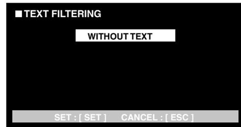
Manœuvrer le volant de commande par impulsions pour choisir OFF, WITH TEXT ou WITHOUT TEXT.
