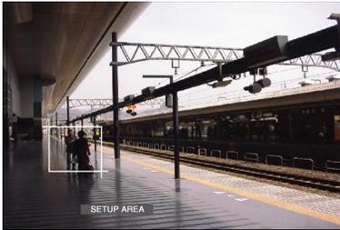
Appuyer sur le bouton SET pour déterminer la position sélectionnée comme point de fin de session de secteur de détection de mouvement.
